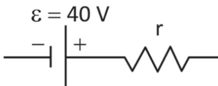
O eletrotécnico construiu um circuito que permite à bomba-d'água operar corretamente com o menor número possível de placas conectadas. Para isso, desenhou um diagrama no qual todas essas placas são representadas como um único gerador não ideal, com a especificação das correspondentes características elétricas.
