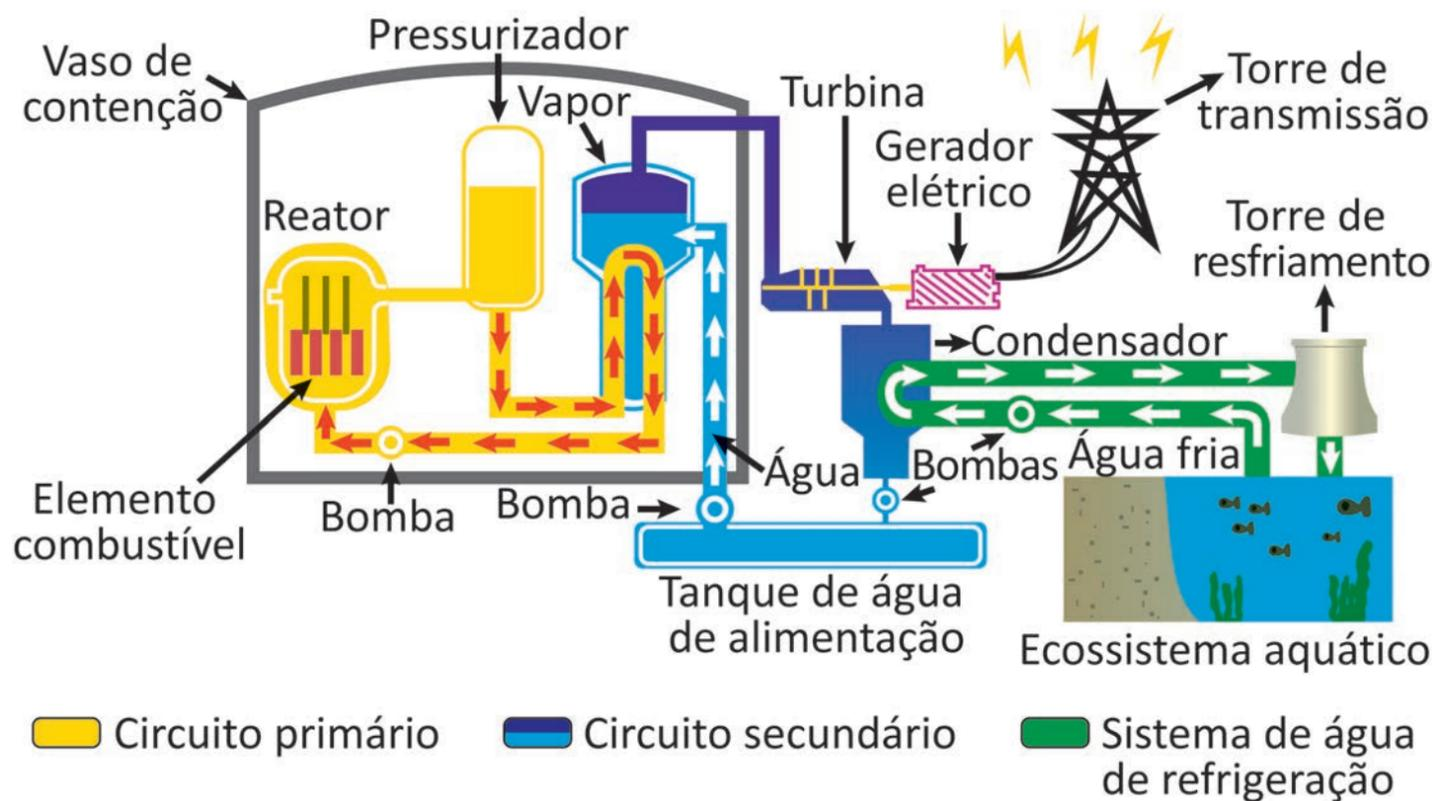
Durante a operação da usina, se o sistema de água de refrigeração funcionar de forma ineficiente pode causar poluição térmica, comprometendo a vida no ecossistema aquático.
