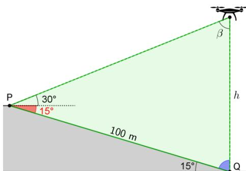
Deduz que o ângulo vermelho é alterno interno em relação ao ângulo de inclinação da rampa, que é  $15^\circ$ . Com isso deduz que o ângulo vermelho mede  $15^\circ$ . Além disso, observa que o ângulo de cor azul é complementar ao ângulo de  $15^\circ$ , portanto mede  $90^\circ - 15^\circ = 75^\circ$ .
